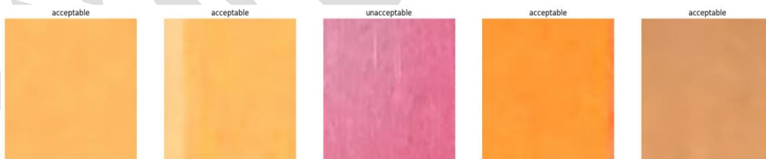
شکل ۱۵. نمونه رنگ، خوردگی قطعات موتوری در اثر عنصر مس موجود در روغن موتور
